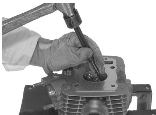
INSTALADOR DA GUIA DA VÁLVULA
