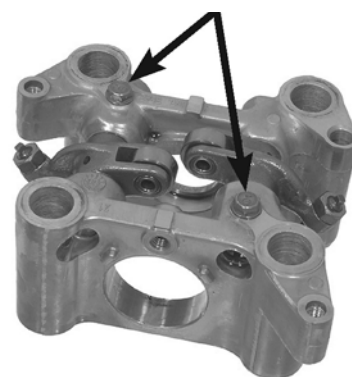
PLACA RETENTORA ÁRVORE DE COMANDO PARAFUSOS DO EIXO DO BALANÇIM
