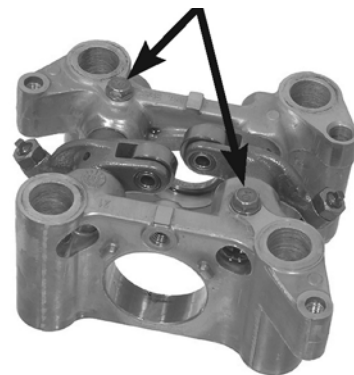
PARAFUSOS DO EIXO DO BALANCIM
