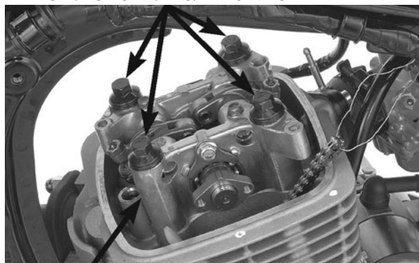
SUPORE DA ÁRVORE DE COMANDO PARAFUSO DA PLACA RETENTORA
